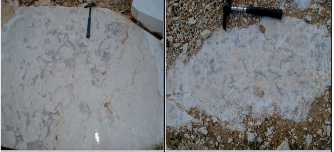
Şekil 1.61: Akhisar bölgesinde bej renkli kireçtaşları içinde gözlenen siyah renkli alg yapıları. Bu yapıların çokluğu taşın pazar bulma şansını azaltmaktadır.
