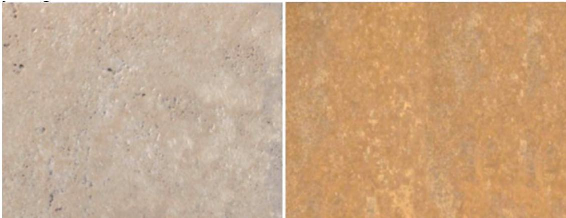
Şekil 5.122: Keban bölgesinde Bayraklar firması tarafından üretilen light ve sarı traverten.
