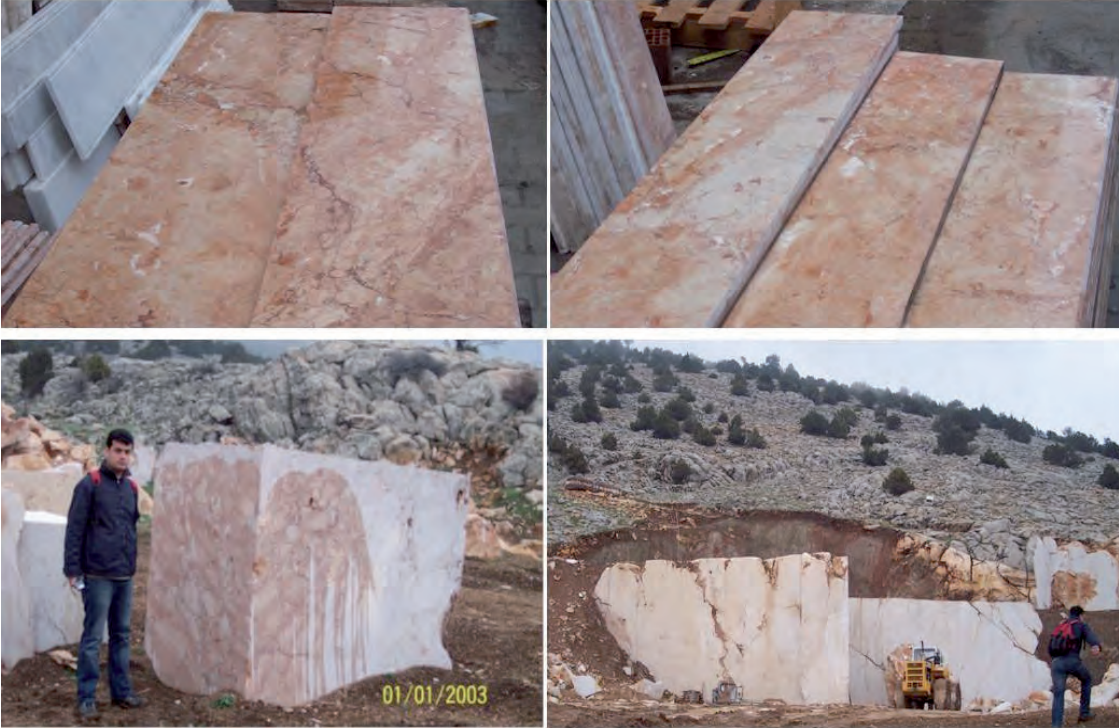
Şekil 4.15: Korkuteli kuzeyinde, Yelten kasabasının batısında bulunan Yelten yaylasında faaliyet gösteren yerel bir firmaya ait ocak ve bu ocakta, megaladon fosilli bej mermerler ile birlikte üretilen Rosa Verona mermerinin, aynı firmanın Korkuteli'ndeki işletmesinde kesilmiş plakaları.
