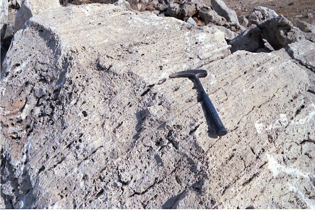
Şekil 5.15: Karaseki bölgesindeki ticari anlamdaki travertenlere bir örnek. Kayaç açık renkli ve belirgin tabakalanmalıdır. Boşluklar genelde tabakalanmaya paralel dizilimlidir.
