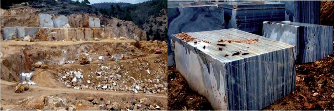
Şekil 3.70: Uşak siyah mermer ocağı görüntüsü ve buradan üretilen Uşak siyah mermer blokları.
