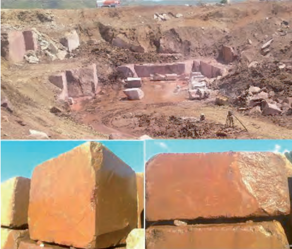
Şekil 4.33: Konya ili Bozkır ilçesi Sorkun köyünün güney batısında yer alan Enhoş mermer firmasına ait Rosso ducale mermer ocağı ve burada üretilen bloklar.
