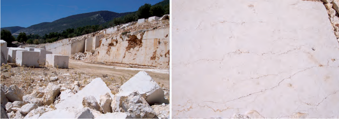
Şekil 1.114: Şhing ocağından 4.5 km batıda açılıp tektonikten dolayı terk edilmiş ocak ve çok çatlaklı gözlenen bloklar.
