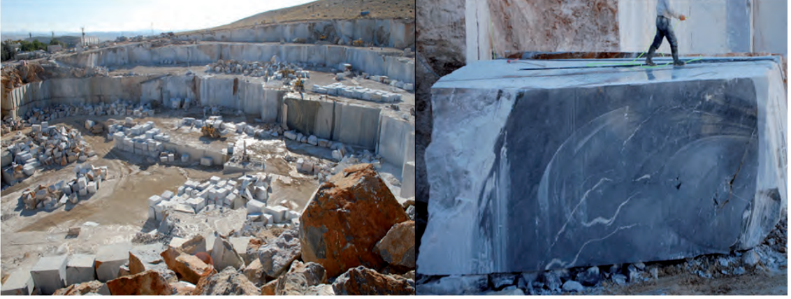
Şekil 3.73: Kütahya siyah mermer ocağı görüntüsü ve ocakta üretim sırasında yeni devrilmiş olan mermer bloğu.
