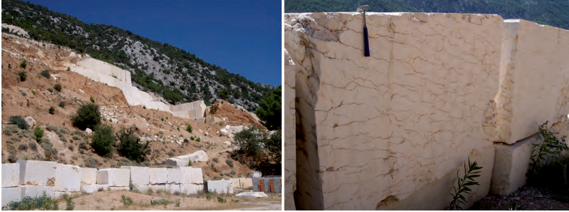
Şekil 1.113: Ara bölgede tektonik hat üzerinde açılmış olan Şhing ocağı ve bu ocaktan çıkarılmış ancak kullanılmamış çatlaklı bloklar.
