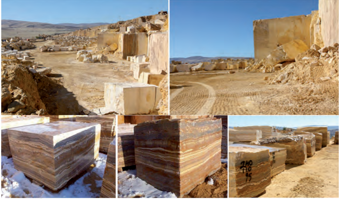
Şekil 5.166: Özmersan mermer firmasının Yıldızeli Sıcakçermik sahasında oniks ürettiği ocak ve burada üretilen Tiger oniks (Sivas tiger oniks) blokları.
