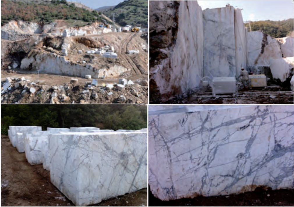
Şekil 1.69: Akçakırsak köyü yakınında bulunan Tuana mermer firmasına ait Iceberg white ve Iceberg blue mermerlerinin üretildiği ocak ve burada üretilen bloklar.
