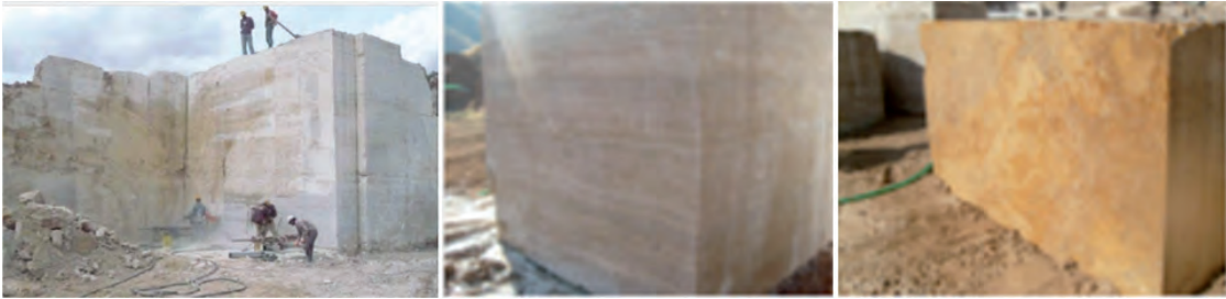
Şekil 5.139: Bitlis ilinin kuzeyinde, Ekinli köyünün yakınında üretim yapan İzba mermer firmasının traverten ocağı ve bu ocakta üretilen beyaz (light) ve sarı (yellow) traverten.
