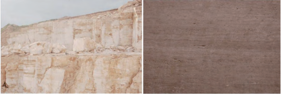
Şekil 5.119: Dağdelenler (DM2) mermer şirketinin Elazığ merkezde bulunan ocağı ve bu ocakta üretilen Noçe traverten.
