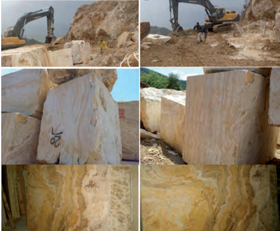
Şekil 5.190: Coşkun madencilik firması tarafından Alaşehir Bahçecik köyünde açılan traoniks ocağı ve bu ocakta üretilen blok ve plakalar.
