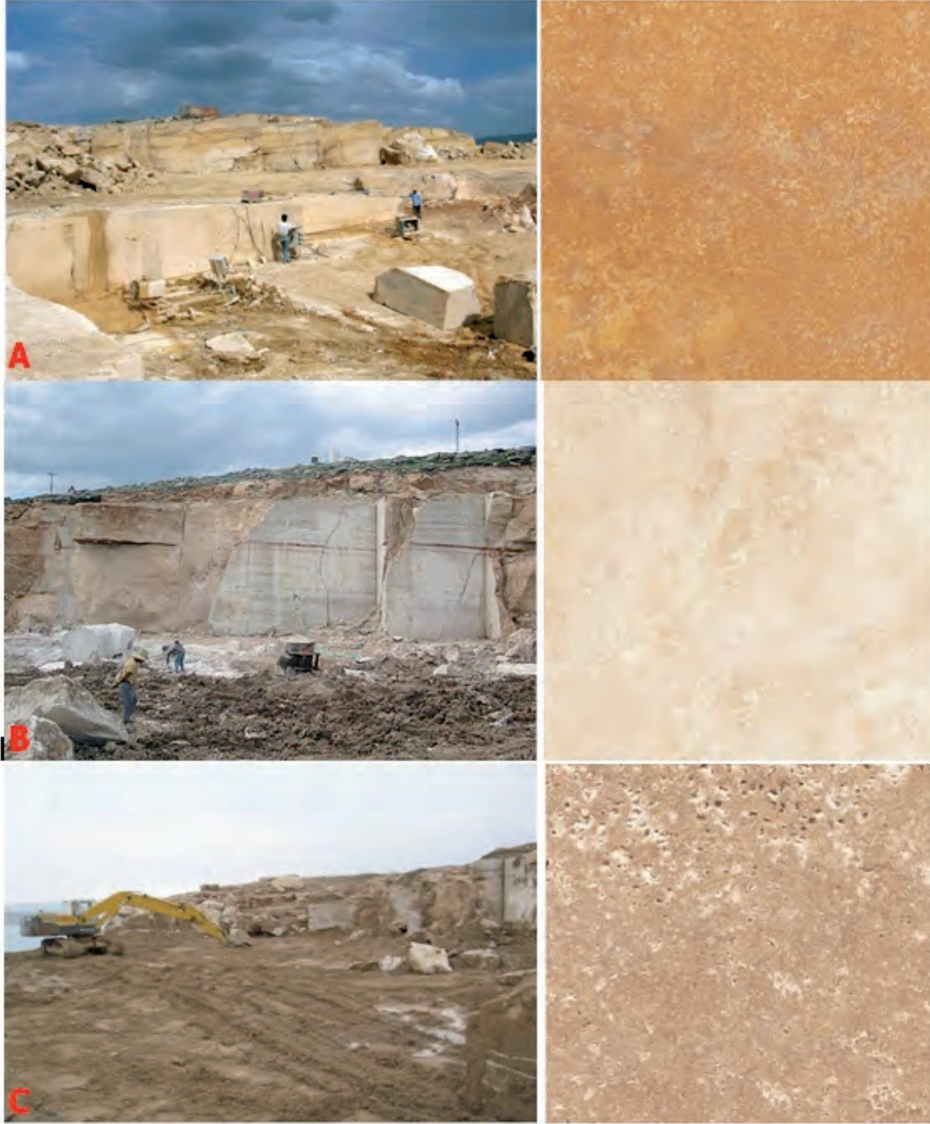
Şekil 5.123: Elazığ ili batısında Suyatağı, Ağın arasındaki bölgede Elmad mermer firmasının traverten ocakları ve üretimleri. A= Gold traverten B= Light traverten C= Noçe traverten.
