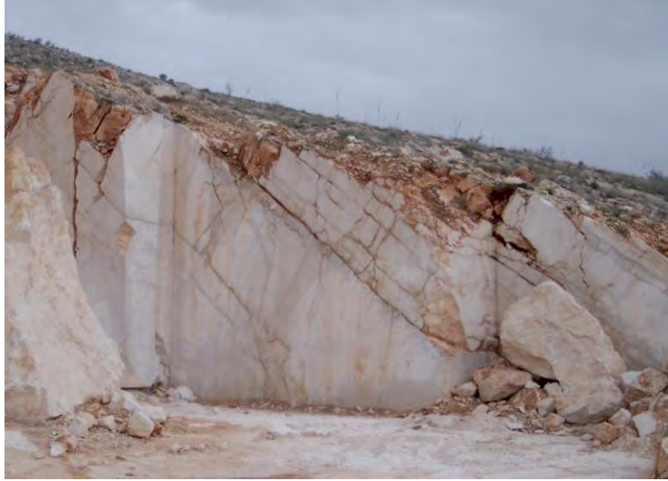
Şekil 1.101: Kale tepe kuzey ucunda çalışan ve 2013 yılında resifal bölgenin bitmesiyle terk edilen Koçer mermer'e ait açık renkli bej ocağının güney ucunda tabakalanmanın ortaya çıkışı.
