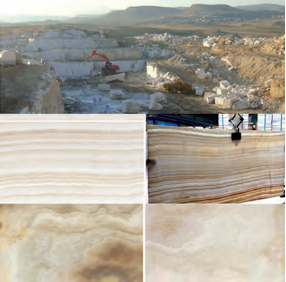
Şekil 5.163: Ağrı Diyadin Taşbasamak köyünde bulunan Akdağ oniks mermer ocağı ve bu ocakta üretilen Akdağ oniks vein cut ve Akdağ oniks cross cut.
