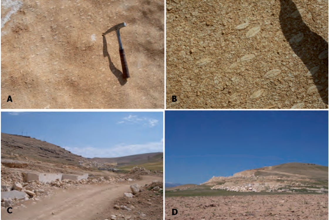
Şekil 1.164: A ve B =Elazığ sunta mermerinin üretildiği kireçtaşlarında gözlenen ve boyları birkaç cm yi bulan Nummulites fosilleri C ve D= Elazığ sunta ocakları.
