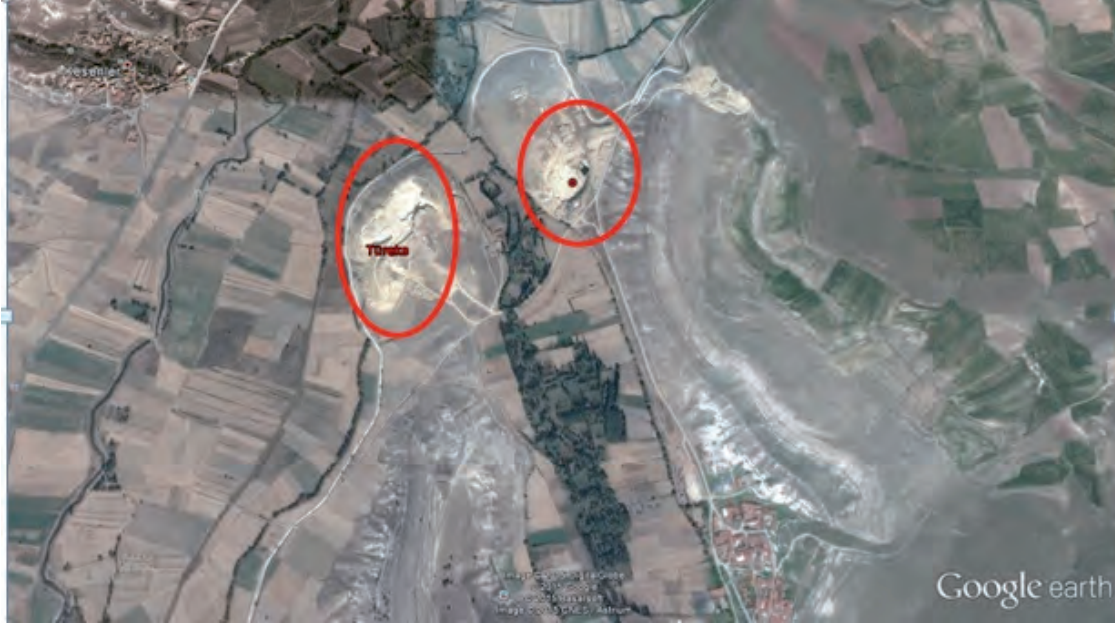
Şekil 5.51: Türeks mermer firmasına ait traverten ocağı. Ocağın açıldığı Alt-Orta Miyosen yaşlı gölsel kireçtaşı, marn, şeyl olarak gösterilen birimin konumu net olarak gözlenmektedir.
