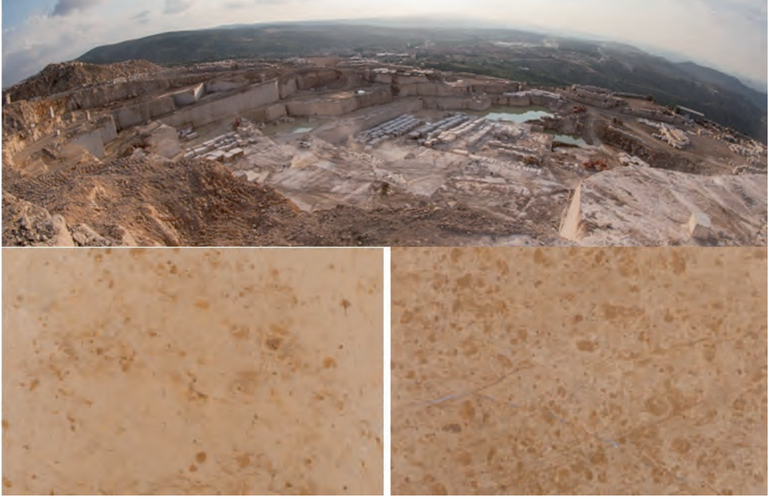
Şekil 5.49: Söğüt, Sırhoca köyü yakınlarında bulunan Gökyar mermer firmasına ait Golden traverten ocağı ve burada üretilen Golden traverten.
