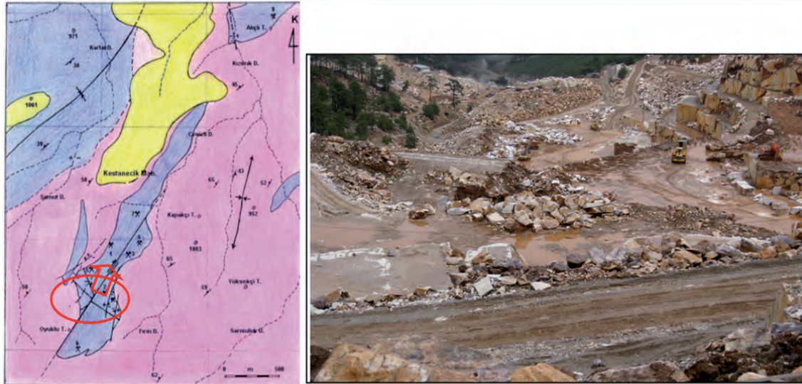
Şekil 2.17: A: Salkım köyünün güneyinde bulunan Kestanecik mahallesi ve çevresinin jeolojik haritası. Mavi renk mermer, kırmızı şist, sarı ise alüvyonu gösterir ( Oğulcan, R. 1992 den düzenlenerek). B: A’da bakış yönü de gösterilen eski Ege maden ocağının fotoğrafı. Bu işletmelerde Milas leylak, Milas Newyork, Milas limon, Milas sedef ve Milas beyaz türü mermerler aynı ocakta üretilmektedir. Mermerlerdeki bu renk değişimi, üretim noktasının, mafik metavolkanitler ile olan uzaklıkları ile ilgilidir
