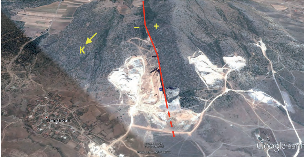
Şekil 5.148: Harmandalı oniks ocağı ve ocağının oluşumunu sağlayan KB-GD uzanımlı fay. Çevredeki diğer işletmeler taş ocağıdır.
