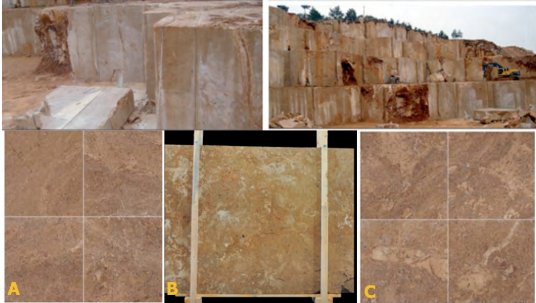
Şekil 5.55: Ermaş firmasına ait Muğla Fethiye Kemer beldesinde bulunan Karia noçe traverten ocağı ve bu ocakta üretilen travertenler. A ve B= Noçe trv. C= Arizonya trv.
