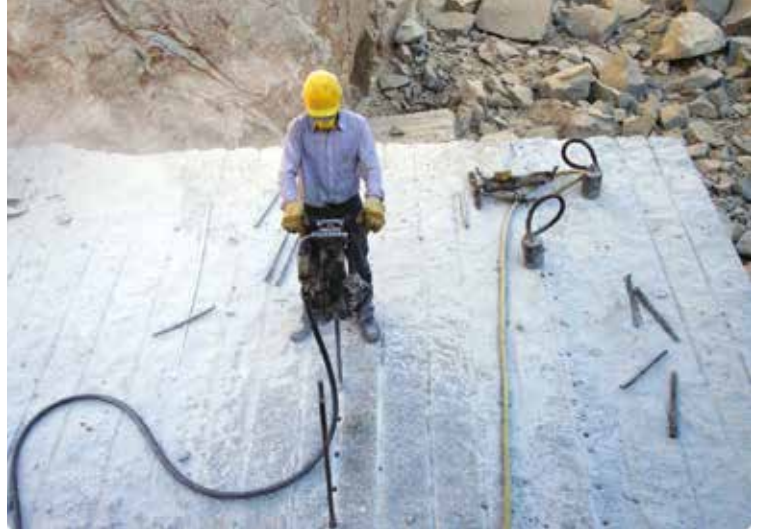
Granit ocaklarında havalı delici tabancalar kullanılarak yapılan blok üretimi
