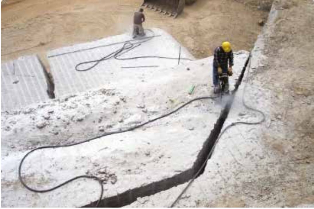
Granit ocaklarında üçlü kama ve havalı delici tabancalarla yapılan blok üretimi
